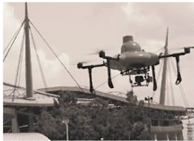
消防用ドローン
